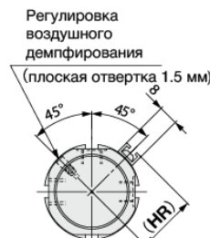
Монтаж датчика на планке (А)
