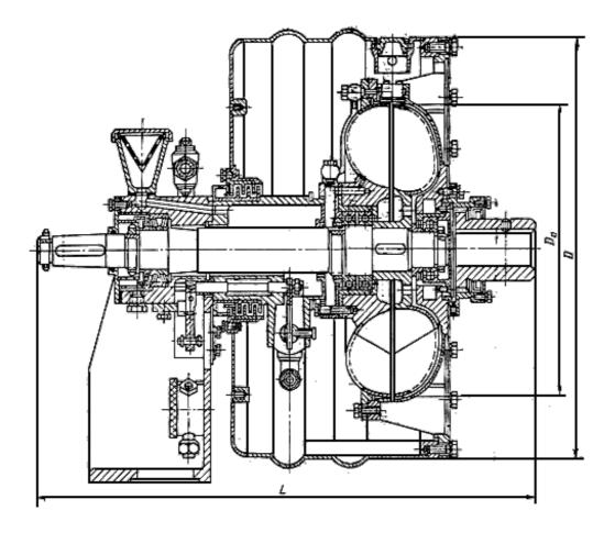
Примечание. Чертеж не определяет конструкцию гидродинамической муфты.
