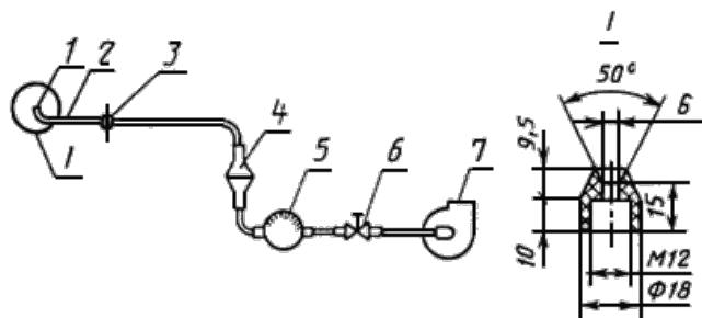
1 - насадка; 2 - воздухозаборная труба; 3 - поворотное устройство;
