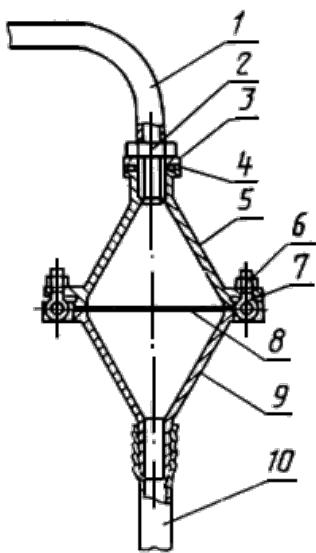
1 - трубка соединительная; 2 - гайка; 3 - шайба; 4 - прокладка; 5 - крышка;
