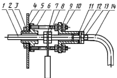
1 - воздухозаборная трубка; 2 - втулка; 3 - гайка; 4 - стенка камеры; 5 - прокладка;
