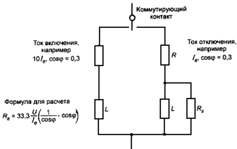
Рисунок 7 - Схема нагрузки L(d) для условий испытаний, требующих различных значений токов включения и отключения и/или коэффициентов мощности (постоянной времени)
