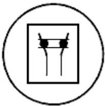
Рисунок L.2 - Символ маркировки аппарата, содержащего механически связанные контакты
